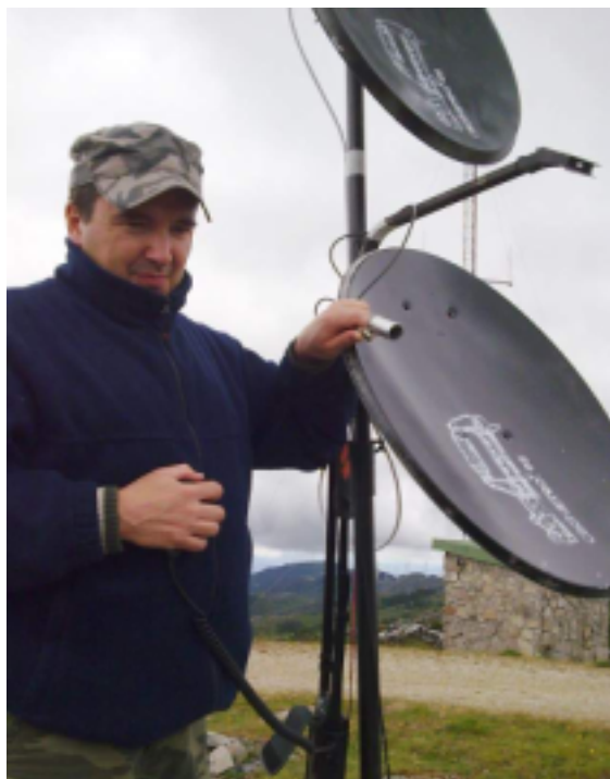
(fig. 15) EA1HBX con el guiaonda transmisor de 5/4 sin bocina
