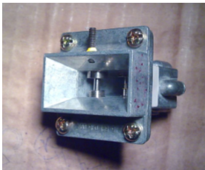
(fig. 1) cavidad doppler gunn 10 GHz
