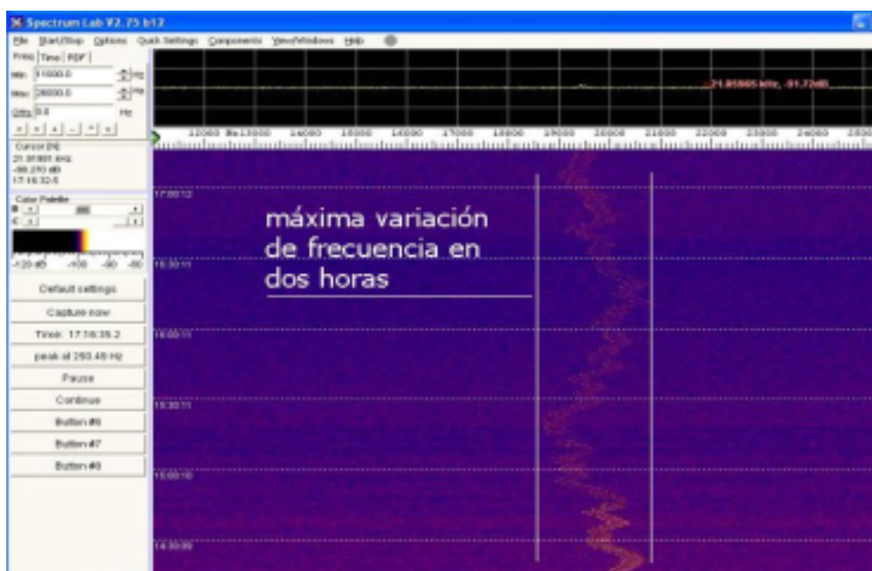
(fig. 14) medición de estabilidad del nuevo LNB
