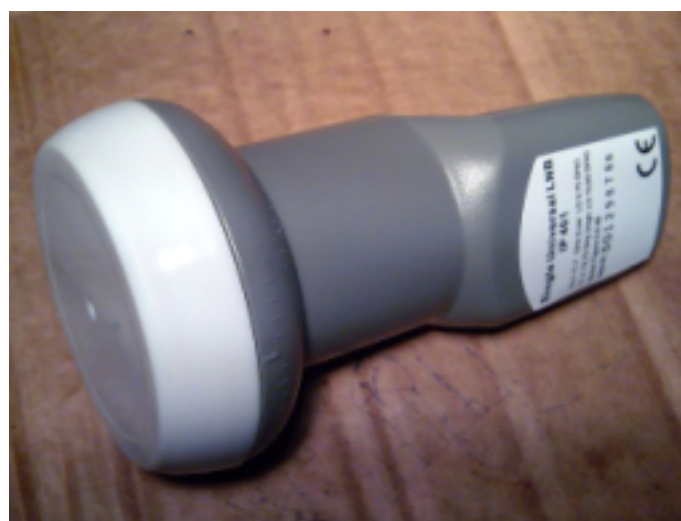
(fig. 3) LNB comercial para recepción de TV
