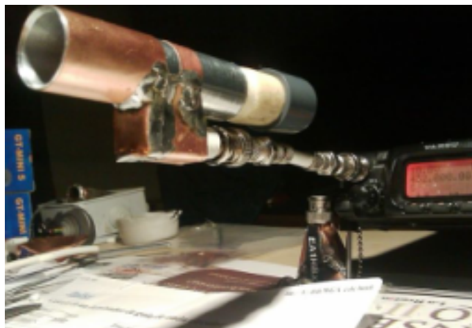
(fig. 6) primer prototipo de guiaonda (diam.int. 19 mm)
