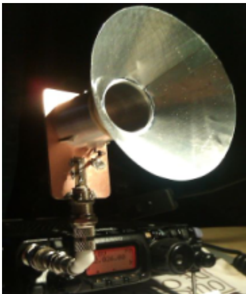
(fig. 7) guionda optimizada con bocina (diam.int. 22mm)
