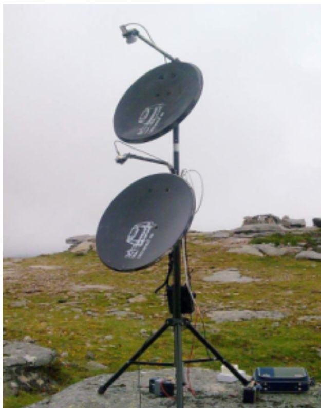
(fig. 13) parábolas offset SAT adaptadas a uso terrestre
